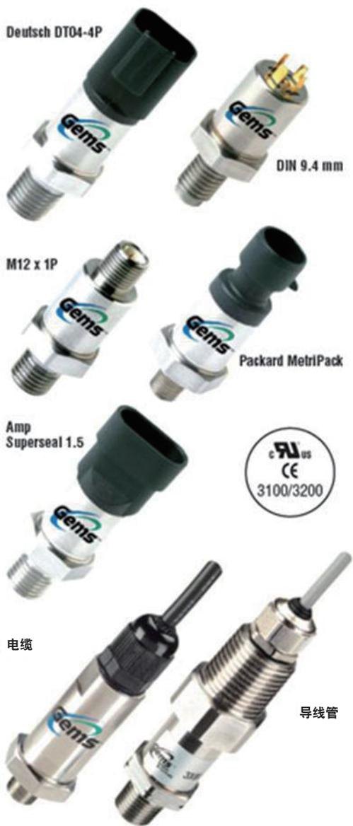
为了更深入地了解传感器的功能，我们以对于风机的顺利运行至关重要的液压系统为例。不论是通过控制桨距和偏航来优化风机，从而在不同风况下提高发电量，还是为了保护风机不受损坏，液压系统都起到了非常重要的作用。液压压力损失会降低风机性能，而压力损失导致昂贵的风机部件损坏则会带来更为严重的后果。在大多数风机中，液压系统都是通过泵机将系统蓄能器增压至一定压力来驱动的。然后泵机可以关闭以便节省电力并降低磨损，因为此时蓄能器可以将泵机传递的压力储存起来。蓄能器还可以吸收来自于泵机的压力脉动，防止将其传递到管道中。系统蓄能器中的压力一泄完，泵机就会再次打开向其加压。在一般情况下，蓄能器先增压至225psi，然后泄压至185psi，之后重新增压至225psi。为了保证泵机在适当的时间打开或关闭以维持足够的压力，详细跟踪系统蓄能器中的压力是十分重要的。这个关键的跟踪工作正是由压力传感器完成的，为风机的高效运行发挥了关键的作用。
